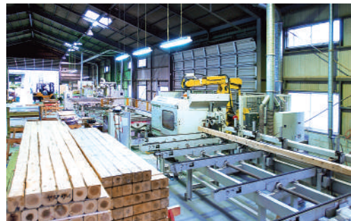
山見坂工場 柱:全自動加工機2ライン 羽柄材加工機:コンピュータロボットシステム加工機2ライン 合板加工機:コンピュータ合板割付加工機2ライン
